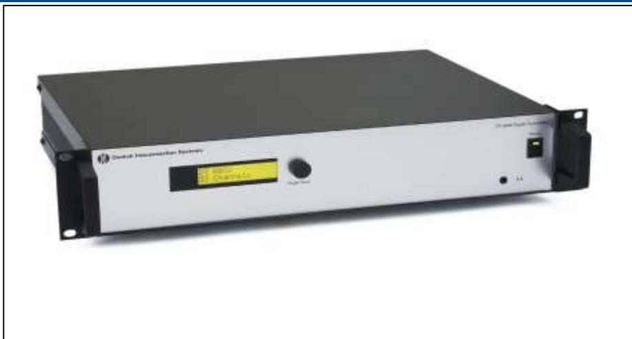
Цифровой передатчик DT 6008 – это центральный модулирующий блок в ИК системе распределения каналов. Он принимает аудио сигналы от модуля аналоговых выходов АО 6004/8. DT 6008 модулирует эти сигналы в несущие.
